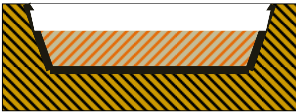
(a) Disposição sem cobertura em reservatório escavado no solo natural
