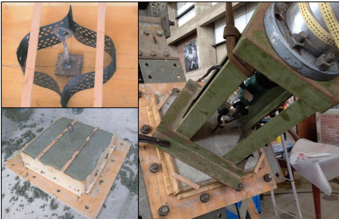
**Figura 2.** Preparação dos corpos de prova e teste de “Pull Out”.
