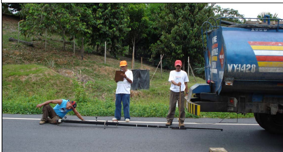
FOTO 7: Ensaio de seguimento usando a Viga Benkelman no ano 2007
