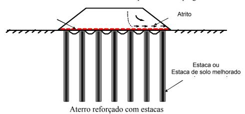
Se materiais drenantes são empregados, os geossintéticos podem ser especificados apropriadamente a fim de também contribuir com a aceleração dos recalques devido ao adensamento do solo mole.
