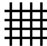
**Georredes** são materiais com aparência semelhante à das grelhas formados por duas séries de membros extrudados paralelos, que se interceptam em ângulo constante. Possui alta porosidade ao longo do plano, sendo usada para conduzir elevadas vazões de fluidos ou gases.
