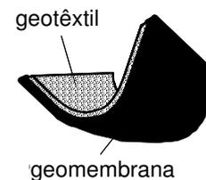
**Geocompostos argilosos (GCL's)** são geocompostos fabricados com uma camada de bentonita geralmente incorporada entre geotêxteis de topo e base ou ligadas a uma geomembrana ou à uma única manta de geotêxtil. Os geotêxteis que compõem os GCLs geralmente são costurados ou agulhados através do núcleo argiloso para
