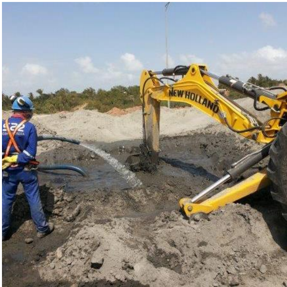
Figura 3(a) – Teste em campo da hidratação do rejeito de cinzas para preenchimento das geoformas.
